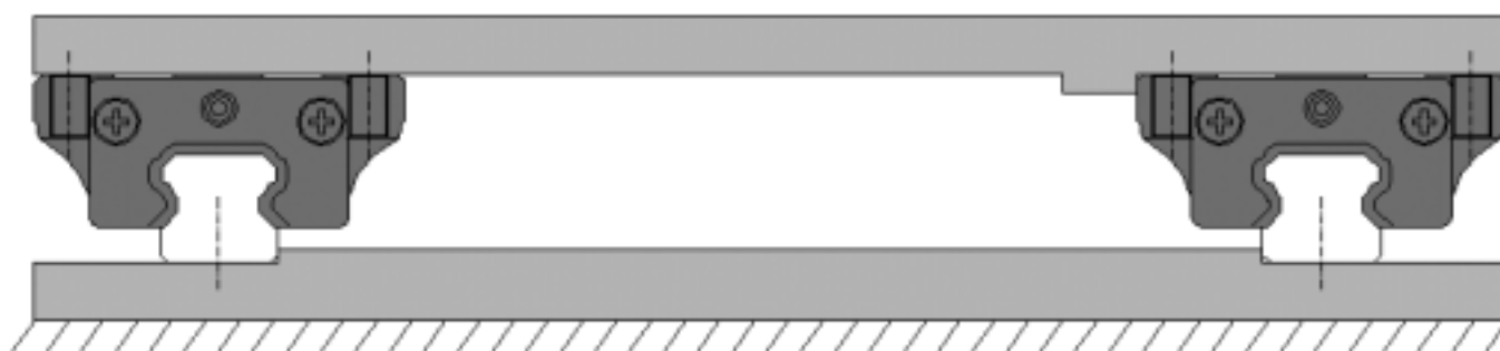
(A) Su piano orizzontale con pattini traslanti (A) Horizontal plane with free blocks
